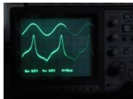
写真 1 交流電圧とひずみ電流
